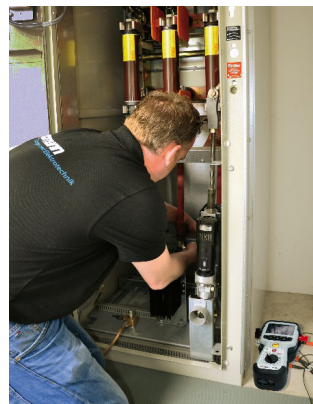
Preparación del Microhmímetro MOM 2
