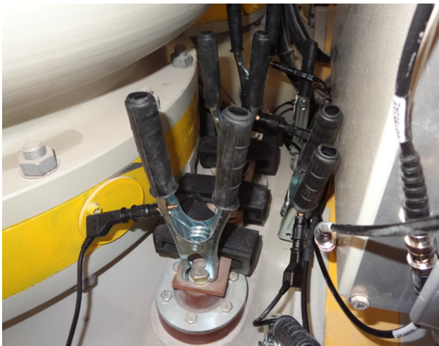
Las ferritas "I" y "C" montadas en el bus de cobre
