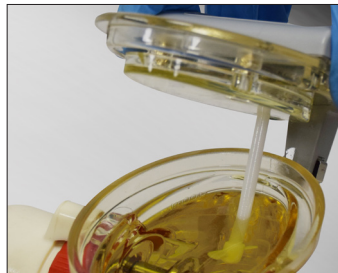
Placa deflectora - Debe entrar en contacto solo con la superficie del aceite. Figura 3
